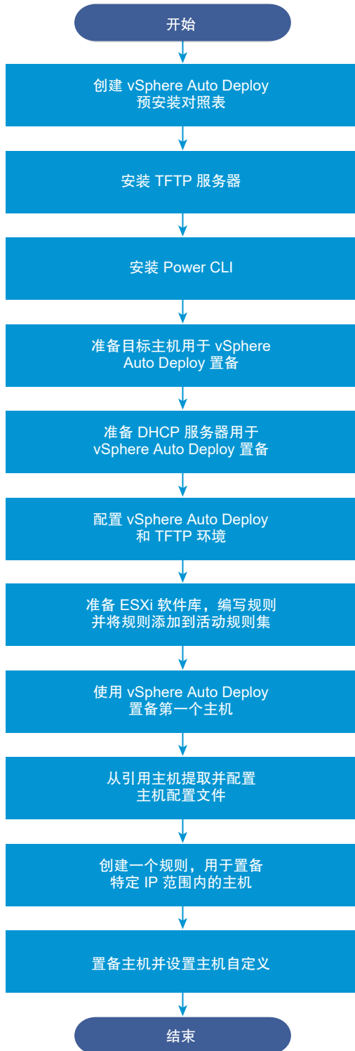
图 5-10. vSphere Auto Deploy 设置和主机置备 workflow
