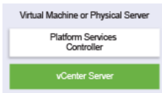
Abbildung 4-1. vCenter Server mit eingebettetem Platform Services Controller
