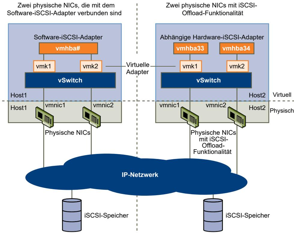
Der iSCSI-Adapter und die physische Netzwerkkarte werden über einen virtuellen VMkernel-Adapter verbunden, der auch als virtueller Netzwerkadapter oder VMkernel-Port bezeichnet wird. Sie erstellen einen VMkernel-Adapter (vmk) auf einem vSphere-Switch (vSwitch) mithilfe einer 1:1-Zuordnung zwischen jedem virtuellen und physischen Netzwerkadapter.
