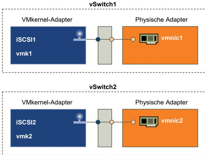
Eine Alternative besteht darin, alle Netzwerkkarten und VMkernel-Adapter zu einem einzelnen vSphere Standard-Switch hinzuzufügen. In diesem Fall müssen Sie die Standardnetzwerkeinrichtung außer Kraft setzen und sicherstellen, dass jeder VMkernel-Adapter nur einem entsprechenden aktiven physischen Adapter zugeordnet wird.
