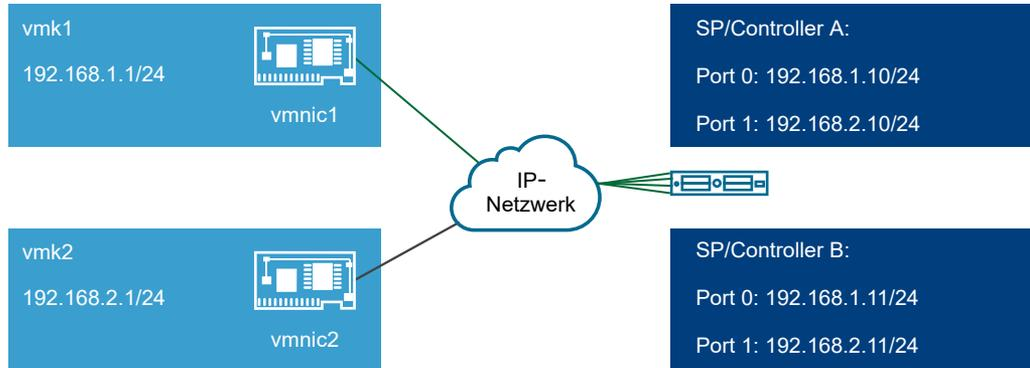
ESXi wählt vmk1 aus, wenn eine Verbindung zu Port 0 von Controller A und Controller B hergestellt wird, da sich alle drei Ports im selben Subnetz befinden. Ebenso wird vmk2 ausgewählt, wenn eine Verbindung zu Port 1 von Controller A und B hergestellt wird. Bei dieser Konfiguration kann die NIC-Gruppierung verwendet werden.
