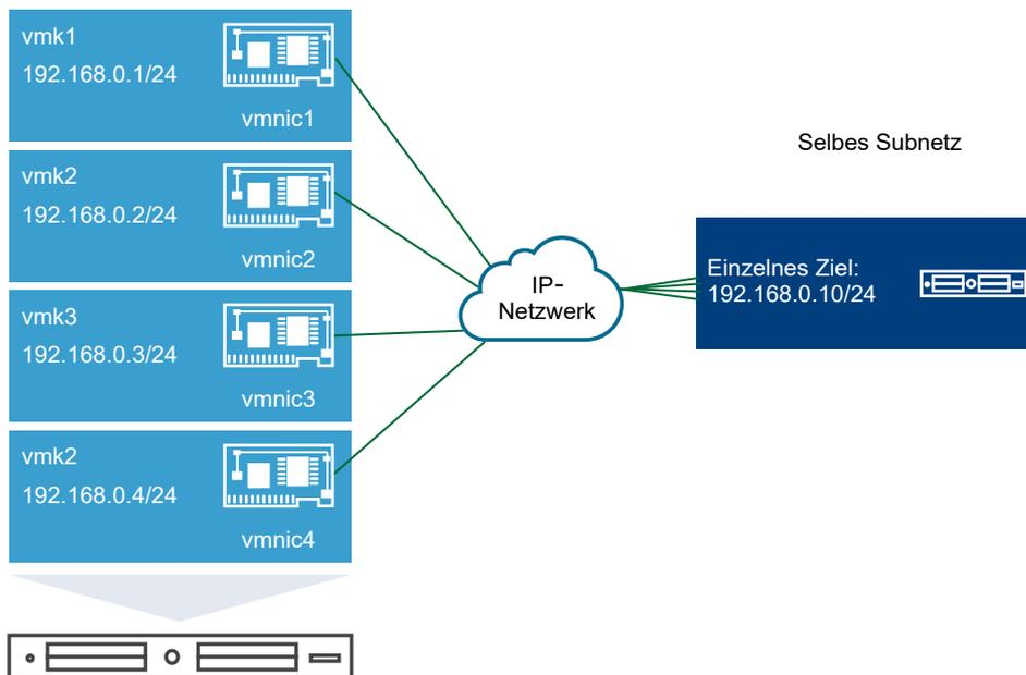
In diesem Beispiel werden alle Initiator-Ports und das Zielportal im selben Subnetz konfiguriert. Das Ziel kann über alle gebundenen Ports erreicht werden. Sie haben vier VMkernel-Ports und ein Zielportal. Es werden also insgesamt vier Pfade erstellt.
