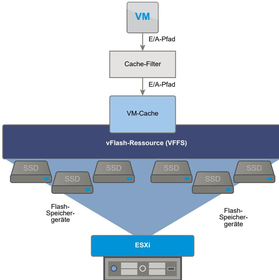
Zum Einrichten einer vFlash-Ressource verwenden Sie Flash-Geräte, die mit dem Host verbunden sind. Wenn Sie die Kapazität der vFlash-Ressource erhöhen möchten, können Sie weitere Flash-Geräte hinzufügen. Ein einzelnes Flash-Laufwerk muss einer vFlash-Ressource exklusiv zugeteilt werden und kann nicht gemeinsam mit einem anderen vSphere-Dienst (z. B. vSAN oder VMFS) genutzt werden.
