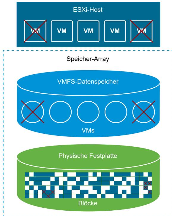
Der Befehl kann auch direkt vom Gastbetriebssystem aus ausgegeben werden. Sowohl VMFS5- als auch VMFS6-Datenspeicher können den über das Gastbetriebssystem ausgegebenen Befehl „Zuordnung aufheben“ unterstützen. Die Unterstützung ist jedoch auf VMFS5 beschränkt.
