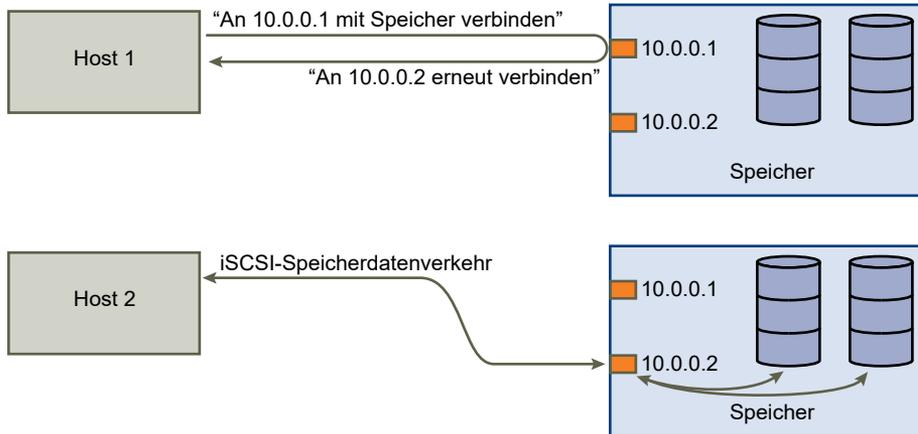
Falls der Port im Speichersystem, der als virtueller Port fungiert, nicht mehr verfügbar ist, weist das Speichersystem die Adresse des virtuellen Ports einem anderen Port im System zu. Die Abbildung „Erneute Portzuweisung“ zeigt ein Beispiel für diese Art der erneuten Zuweisung von Ports. In diesem Fall ist der virtuelle Port 10.0.0.1 nicht mehr verfügbar, und das Speichersystem weist die IP-Adresse des virtuellen Ports einem anderen Port zu. Der zweite Port antwortet an beiden Adressen.
