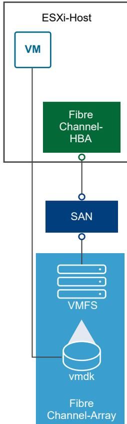
Bei dieser Konfiguration ist der Host mithilfe eines Fibre-Channel-Adapters mit einem SAN-Fabric verbunden, das aus Fibre-Channel-Switches und Speicher-Arrays besteht. LUNs eines Speicherarrays können vom Host verwendet werden. Sie können auf die LUNs zugreifen und Datenspeicher für Ihre Speicheranforderungen erstellen. Die Datenspeicher verwenden das VMFS-Format.
