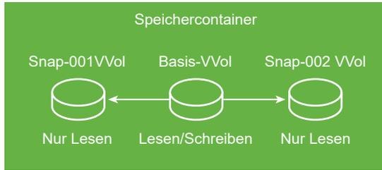
Das virtuelle Basis-Volumen bleibt aktiv oder mit Lese-Schreibberechtigung. Bei Erstellen eines weiteren Snapshots bleiben der neue Status und die Daten der virtuellen Maschine zum Zeitpunkt der Snapshot-Erstellung erhalten.
