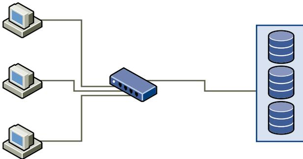
Wenn Systeme Daten aus dem Speicher lesen, reagiert der Speicher mit dem Senden von genügend Daten, um die Verbindung zwischen den Speichersystemen und dem Ethernet-Switch zu füllen. Es ist unwahrscheinlich, dass ein einziges System oder eine einzige virtuelle Maschine die Netzwerkgeschwindigkeit vollständig nutzen. Diese Situation kann jedoch eintreten, wenn viele Systeme ein Speichergerät gemeinsam nutzen.
