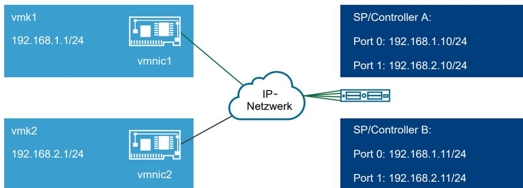
ESXi wählt vmk1 aus, wenn eine Verbindung zu Port 0 von Controller A und Controller B hergestellt wird, da sich alle drei Ports im selben Subnetz befinden. Ebenso wird vmk2 ausgewählt, wenn eine Verbindung zu Port 1 von Controller A und B hergestellt wird. Bei dieser Konfiguration kann die NIC-Gruppierung verwendet werden.
