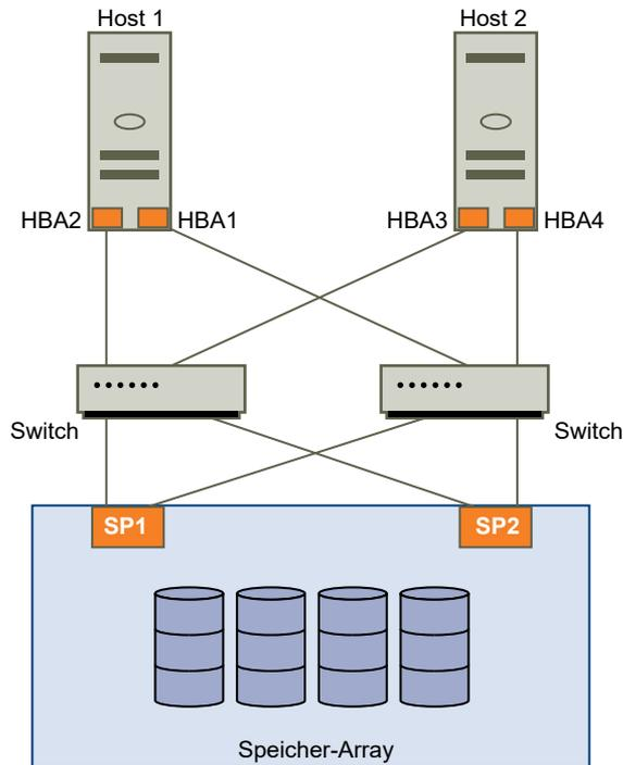
Wenn SP1 oder die Verbindung zwischen SP1 und den Switches ausfällt, übernimmt SP2. SP2 stellt die Verbindung zwischen dem Switch und dem Speichergerät bereit. Dieser Vorgang wird SP-Failover genannt. VMware ESXi unterstützt sowohl HBA- als auch SP-Failover.
