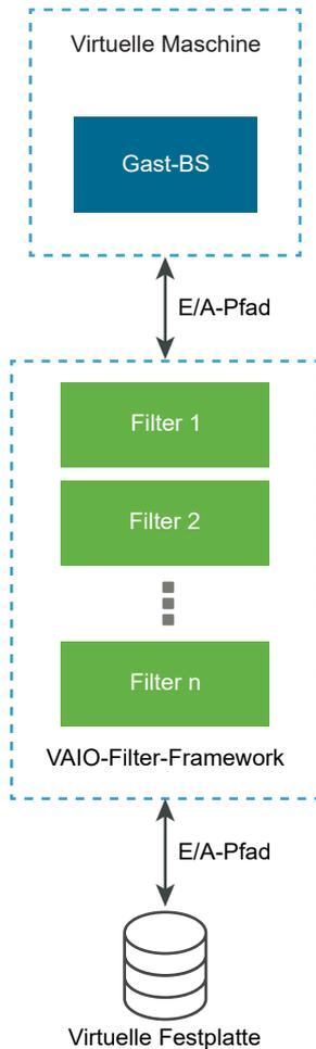
Jede VMX-Komponente (Virtual Machine Executable) einer virtuellen Maschine enthält ein Filter-Framework zur Verwaltung der mit der virtuellen Festplatte verbundenen E/A-Filter-Plug-Ins. Das Filter-Framework ruft Filter auf, wenn die E/A-Anforderungen zwischen dem Gastbetriebssystem und der virtuellen Festplatte übertragen werden. Darüber hinaus fängt der Filter jeden E/A-Zugriff auf die virtuelle Festplatte ab, der außerhalb einer ausgeführten virtuellen Maschine erfolgt.
