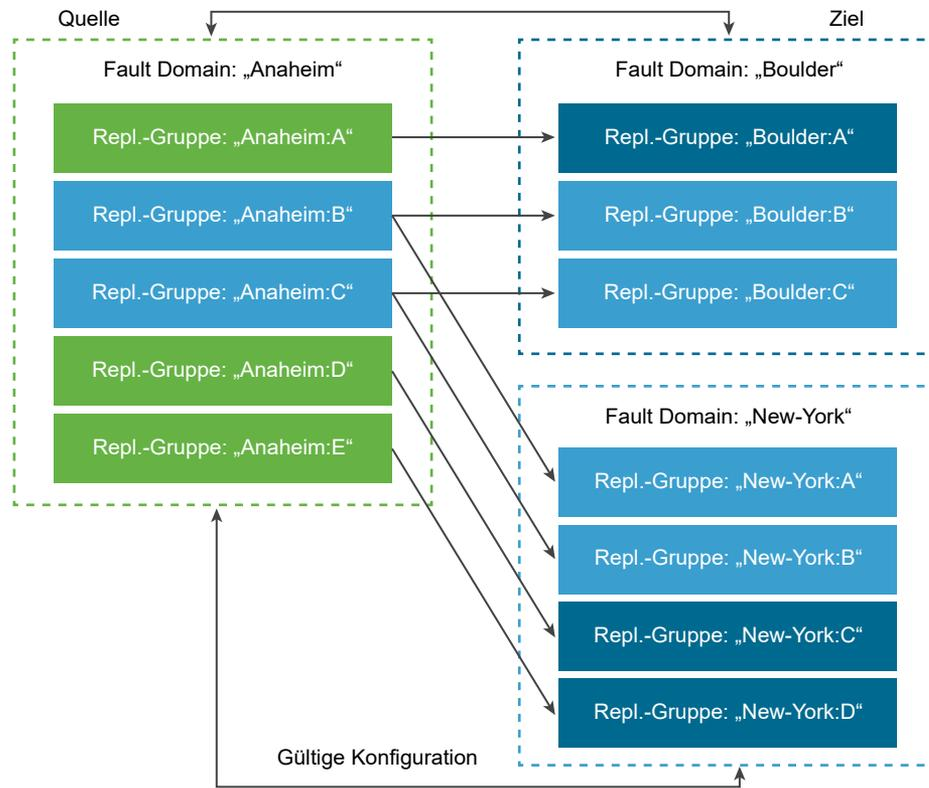
Nun wird eine virtuelle Maschine mit zwei Festplatten bereitgestellt, von denen die eine mit der Replizierungsgruppe Anaheim:B und die andere mit der Replizierungsgruppe Anaheim:D verknüpft ist. Diese Konfiguration ist ungültig. Beide Replizierungsgruppen werden auf die Fault Domain New York, jedoch wird nur eine auf die Fault Domain Boulder repliziert.
