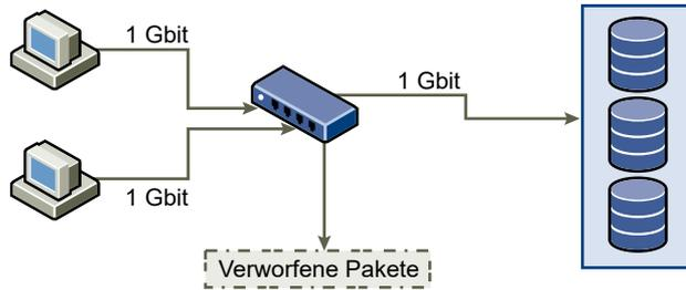
Das Wiederherstellen von verworfenen Netzwerkpaketen führt zu einer erheblichen Leistungsbeeinträchtigung. Neben der Zeit zur Ermittlung, dass Daten verloren gegangen sind, ist für die erneute Übermittlung Netzwerkbroadband erforderlich, die anderenfalls für aktuelle Transaktionen verwendet werden kann.
