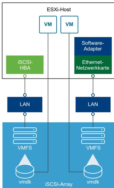
Im linken Beispiel verwendet der Host einen Hardware-iSCSI-Adapter für die Verbindung zum iSCSI-Speichersystem.
