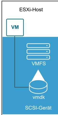
Bei diesem Beispiel einer lokalen Speichertopologie verwendet der ESXi-Host eine einzelne Verbindung zu einer Speicherfestplatte. Auf diesem Gerät können Sie einen VMFS-Datenspeicher erstellen, der zur Speicherung der Festplattendateien der virtuellen Maschine verwendet wird.
