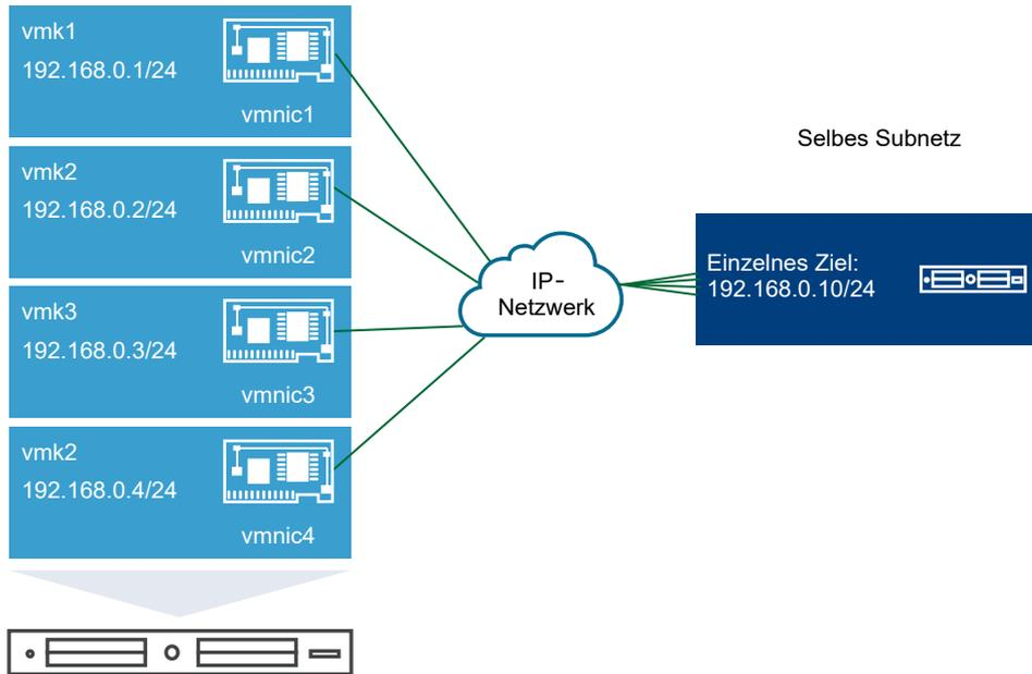
In diesem Beispiel werden alle Initiator-Ports und das Zielportal im selben Subnetz konfiguriert. Das Ziel kann über alle gebundenen Ports erreicht werden. Sie haben vier VMkernel-Ports und ein Zielportal. Es werden also insgesamt vier Pfade erstellt.
