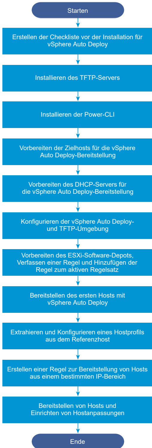
Abbildung 4-11. Workflow für das Setup von vSphere Auto Deploy und die Hostbereitstellung
