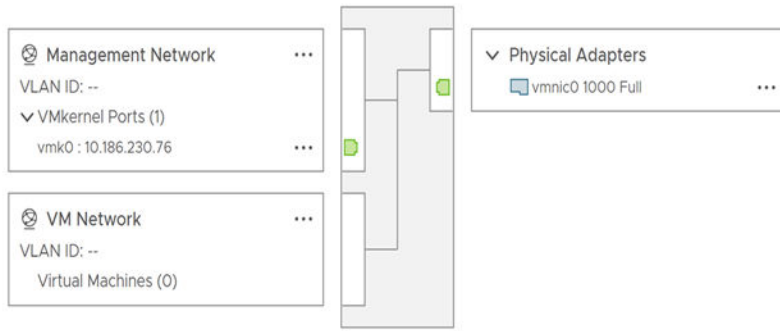
Figura 2-2. Diagrama de topología de un conmutador estándar de vSphere
