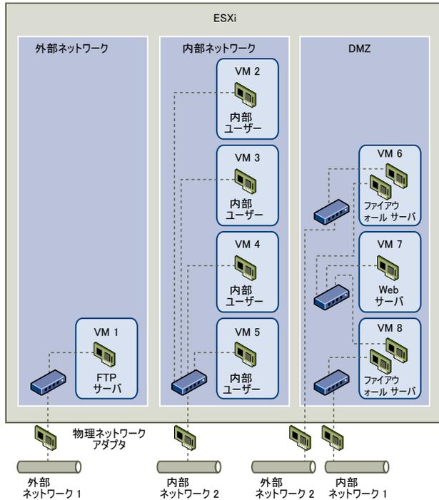
図では、システム管理者が FTP サーバ、内部仮想マシン、DMZ という 3 つの異なる仮想マシンのゾーンにホストを構成しています。各ゾーンのサーバには固有の機能があります。
