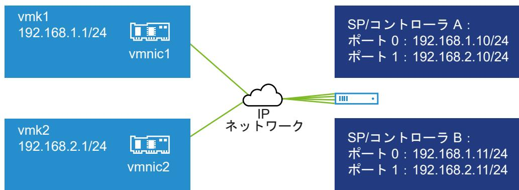
3 つのポートがすべて同じサブネットに属しているため、ESXi はコントローラ A とコントローラ B のポート 0 に接続する際に vmk1 を選択します。同様に、コントローラ A とコントローラ B のポート 1 に接続する際には vmk2 が選択されます。この構成では NIC チーミングを使用できます。
