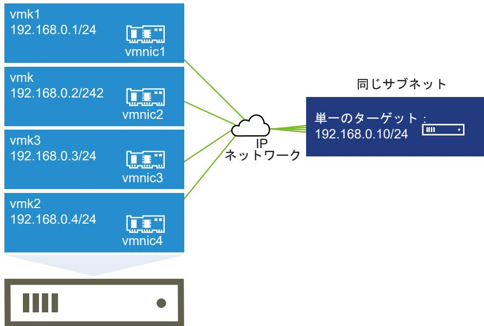
この例では、すべてのイニシエータ ポートとターゲット ポータルが同じサブネットに属しています。また、バインドされているすべてのポートを通じてターゲットに到達できます。VMkernel ポートが 4 つ、ターゲット ポータルが 1 つ存在するため、合計 4 つのパスが作成されます。
