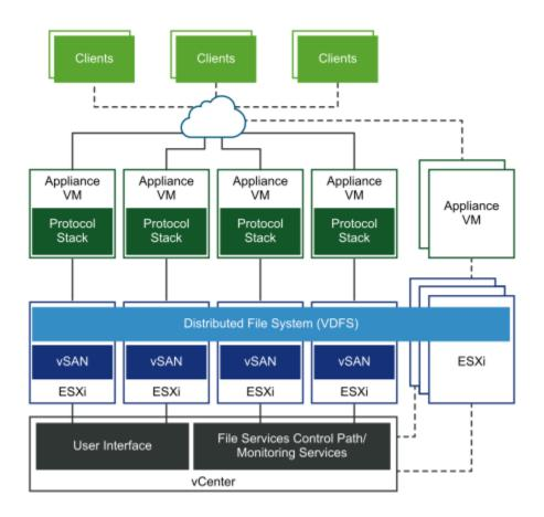
vSAN ファイル サービスを構成すると、vSAN は内部管理用として単一の VDFS 分散ファイル システムをクラス 夕に作成します。各ホストにファイル サービス仮想マシン (FSVM) が配置されます。FSVM は、vSAN データストアのファイル共有を管理します。各 FSVM には、NFS と SMB の両方のサービスを提供するファイル サーバが含まれています。
