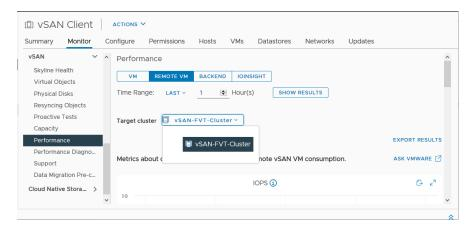
リモート データストアでプロアクティブなテストを実行し、仮想マシンの作成とネットワークのパフォーマンスを確認できます。仮想マシンの作成テストでは、リモート データストア上に仮想マシンが作成されます。ネットワークパフォーマンス テストでは、クライアント クラスタ内のすべてのホストとサーバ クラスタをホストするすべてのホスト間のネットワーク パフォーマンスがチェックされます。
