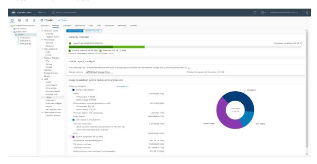
[デデュープおよび圧縮前の使用量の内訳]を確認できるのは、vSphere Client で vSAN キャパシティを監視しているときです。デデュープおよび圧縮の結果に関する情報が表示されます。[有効化前に使用] 容量はデデュープおよび圧縮を適用する前に必要な論理容量を示すのに対して、[有効化後に使用] 容量はデデュープおよび圧縮を適用した後に使用される物理容量を示します。[有効化後に使用] 容量には、節約される容量の量の概要と、デデュープおよび圧縮の比率も表示されます。
