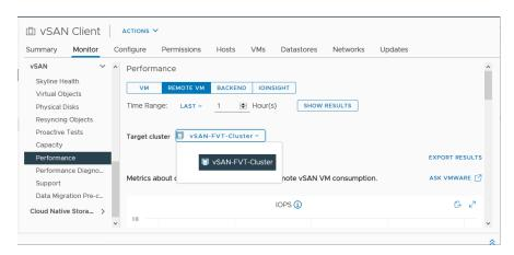
リモート データストアでプロアクティブなテストを実行し、仮想マシンの作成とネットワークのパフォーマンスを確認できます。 仮想マシンの作成テストでは、 リモート データストア上に仮想マシンが作成されます。 ネットワークパフォーマンス テストでは、 クライアント クラスタ内のすべてのホストとサーバ クラスタをホストするすべてのホスト間のネットワーク パフォーマンスがチェックされます。
