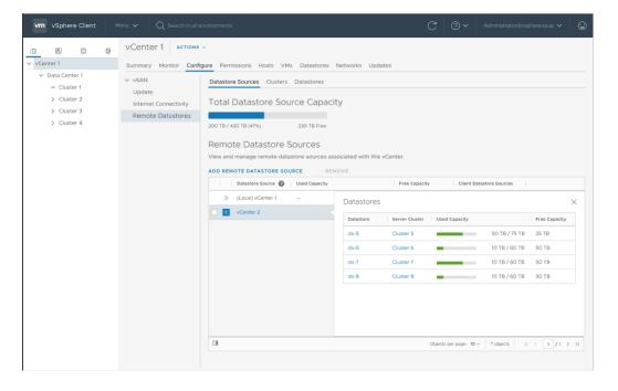
vCenter Server の [リモート データストア] ページを使用して、リモート データストア ソースを管理します([構成] > [vSAN] > [リモート データベース])。タブをクリックして、vCenter Server 間の共有データストアに関する情報にアクセスします。データストア ソースとして vCenter Server を追加し、データストアをローカル クラスタにマウントします。
