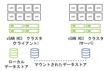
リモート データストア ビューを使用すると、ローカル vSAN クラスタにマウントされたリモート データストアを 監視し、管理できます。各クライアント vSAN クラスタは、サーバ vSAN クラスタからリモート データストアを マウントできます。互換性のある各 vSAN クラスタはサーバとして機能し、他の vSAN クラスタにローカル デー タストアのマウントを許可できます。
