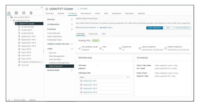
vSAN データ保護では、vSAN スナップショットを管理するために VMware Snapshot Service が必要です。 Snapshot Service アプライアンスを展開して、vSphere Client で vSAN データ保護を有効にします。
