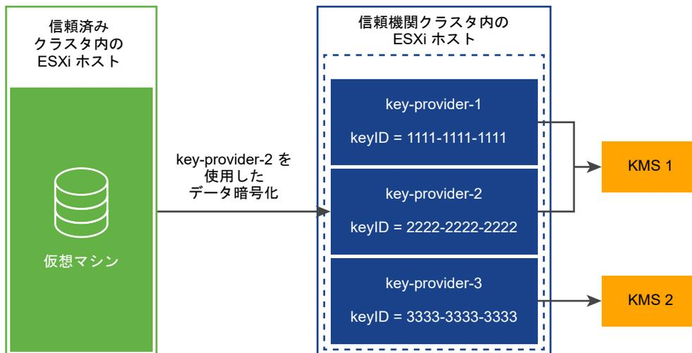
信頼済みクラスタに対して信頼済みキー プロバイダを設定すると、キー プロバイダ サービスは、その信頼済みキー プロバイダに対して暗号化操作を実行する要求を受け入れることができます。たとえば、この図では、3つの信頼済みキー プロバイダ（KMS-1用として2つ、KMS-2用として1つ）が設定されています。信頼済みホストは、キー プロバイダ 2 に対して暗号化操作を要求します。信頼済みホストは、暗号化キーが生成されて返されることを要求し、この暗号化キーを使用して暗号化操作を実行します。
