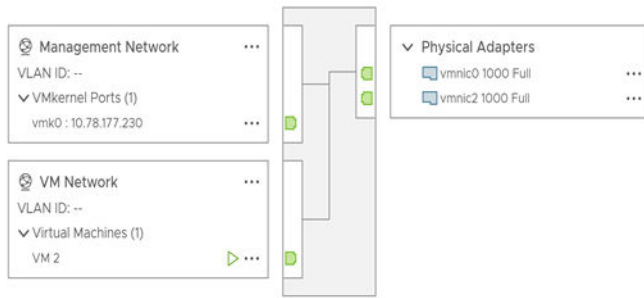
그림 2-2. vSphere Standard Switch의 토폴로지 다이어그램
