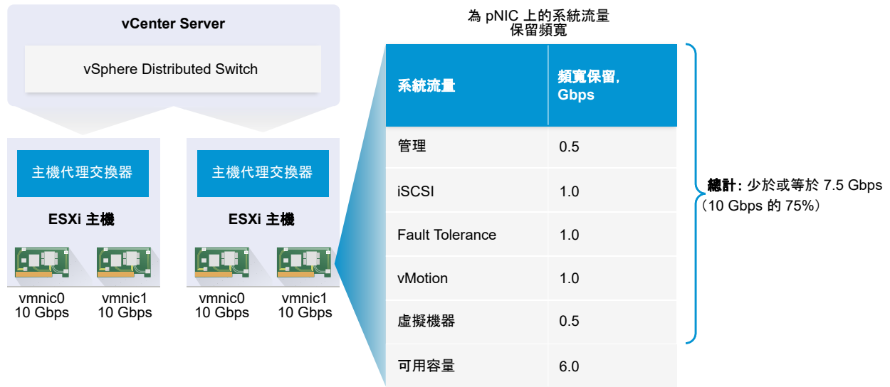
圖 11-1. 用於 10 GbE 實體網路介面卡上系統流量的頻寬保留範例
